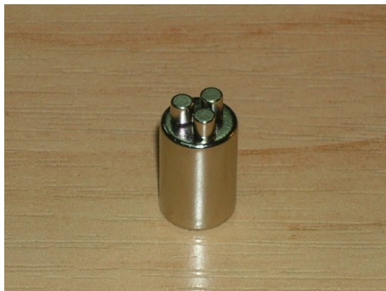
Рис. 6. Магнит № 2 с грузком - противовесом в 480 миллиграмм. С таким противовесом магнит № 2 опускается по трубке с одинаковой скоростью, независимо от того, каким полюсом вниз он опускается.
